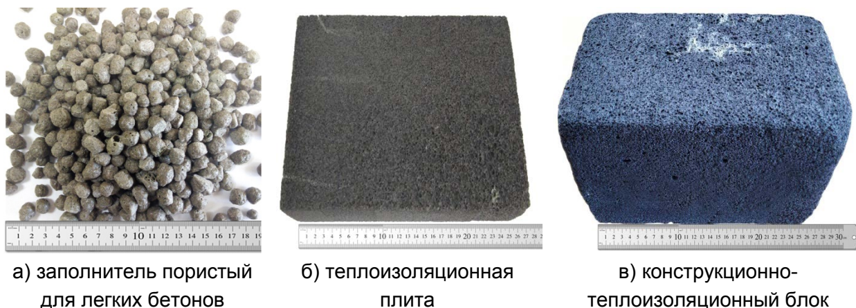
Рис. 3. Изготовленные опытные образцы ячеистых теплоизоляционных строительных стекломатериалов
