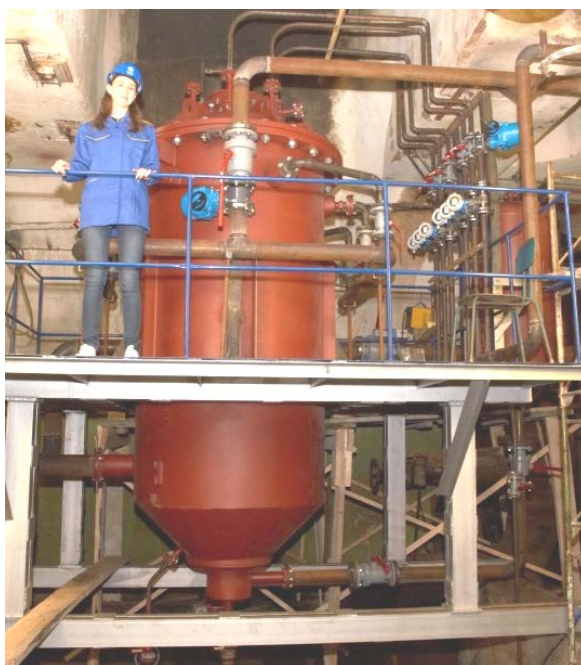
Рис. 2. Деаэрационное устройство. Вид с фронта (фото)
